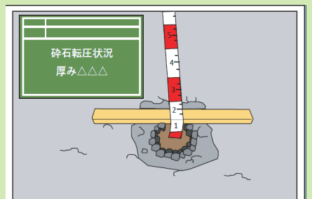
⑤基礎砕石 厚み確認
